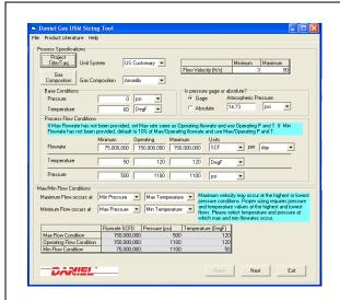
Gas Ultrasonic Meter (USM) Sizing
